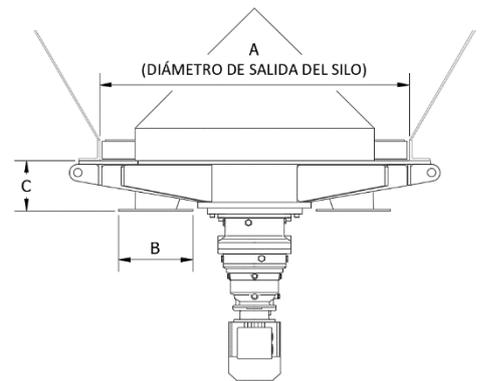
\* Se puede utilizar la opción de caja de cambios de baja velocidad o variador de frecuencia para lograr rendimientos más bajos
