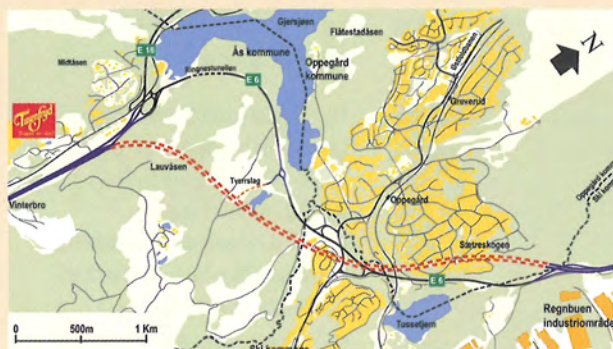
Rød stiplet linje: Ny E6 i tunnel (3,7 km lengde) Blå linjer: Ny E6 i dagsone (1,8 km lengde)
