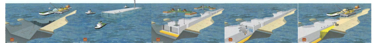
Bjørvikatunnelen blir den første senketunnel i Norge. Betongelementene støpes i dökk utenfor Bergen og slepes inn i Oslofjorden.
