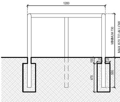
**D** ELEVATION OF SQUEEZE BARRIER.
