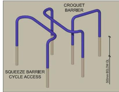
**B** ISOMETRIC OF SQUEEZE BARRIER.
