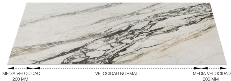
En general, se deberá reducir la velocidad de avance en función de la complejidad del corte, el grosor de la placa y las características técnicas del disco. Es por ello que recomendamos equipos que permitan ajustar sus revoluciones por minuto (RPM), así como también su velocidad de avance.
