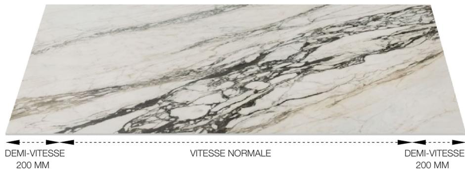
De manière générale, la vitesse d'avance doit être réduite en fonction de la complexité de la coupe, de l'épaisseur de la dalle et des caractéristiques techniques du disque. C'est pourquoi nous recommandons des machines permettant d'ajuster à la fois les tours/minute (RPM) et la vitesse d'avance.
